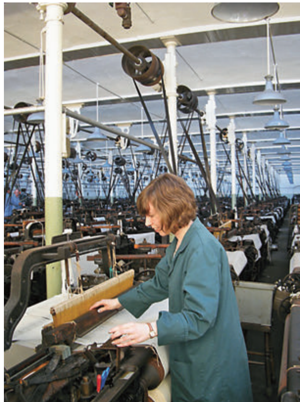
Queen Street Mill, Burnley, Lancashire, England. In der letzten dampfbetriebenen Weberei laufen 300 Webstühle.
