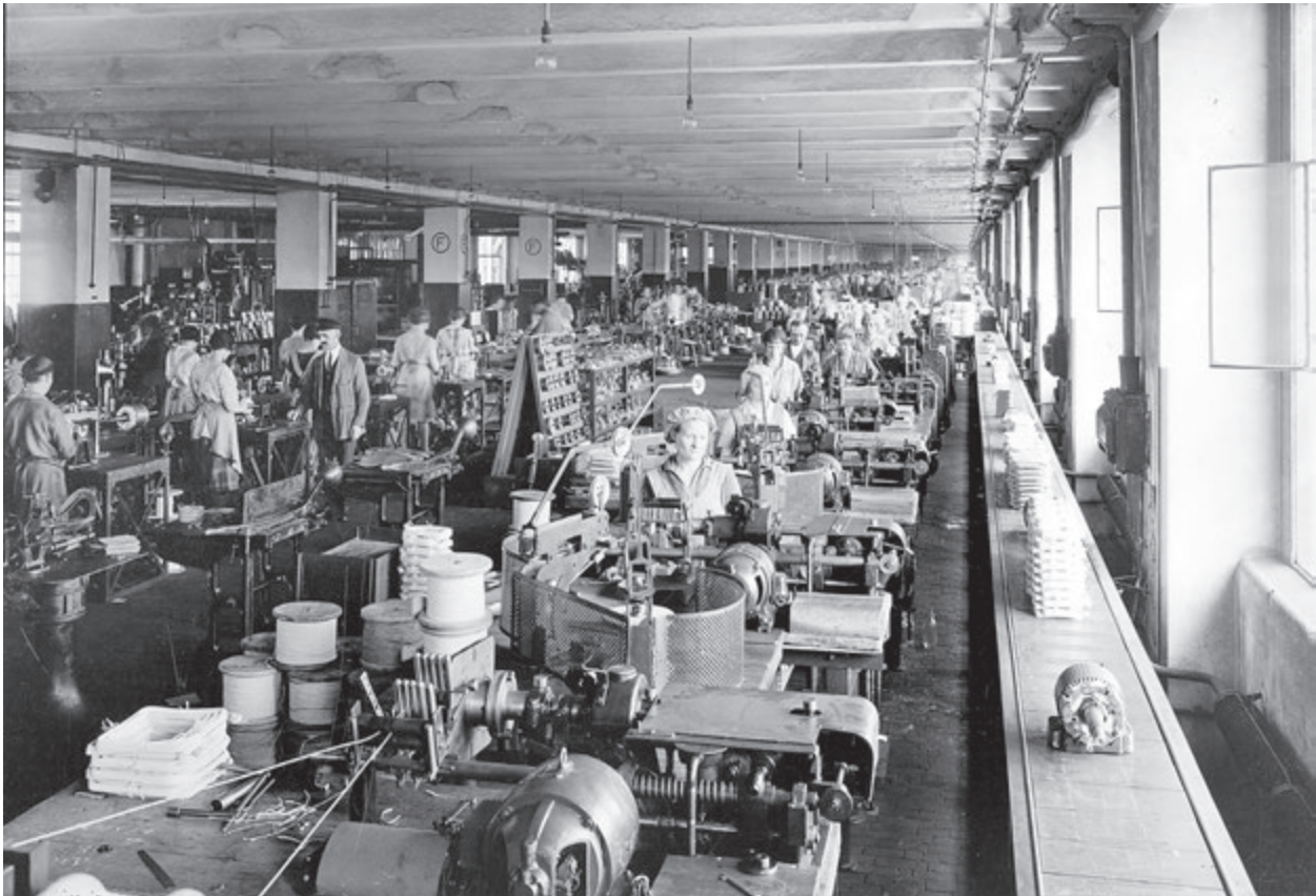
Elektropolis Berlin: In der AEG-Kleinmotorenfabrik produzieren vor allem Arbeiterinnen elektrische Spulen an einem 120 Meter langen Wanderband, 1927.
