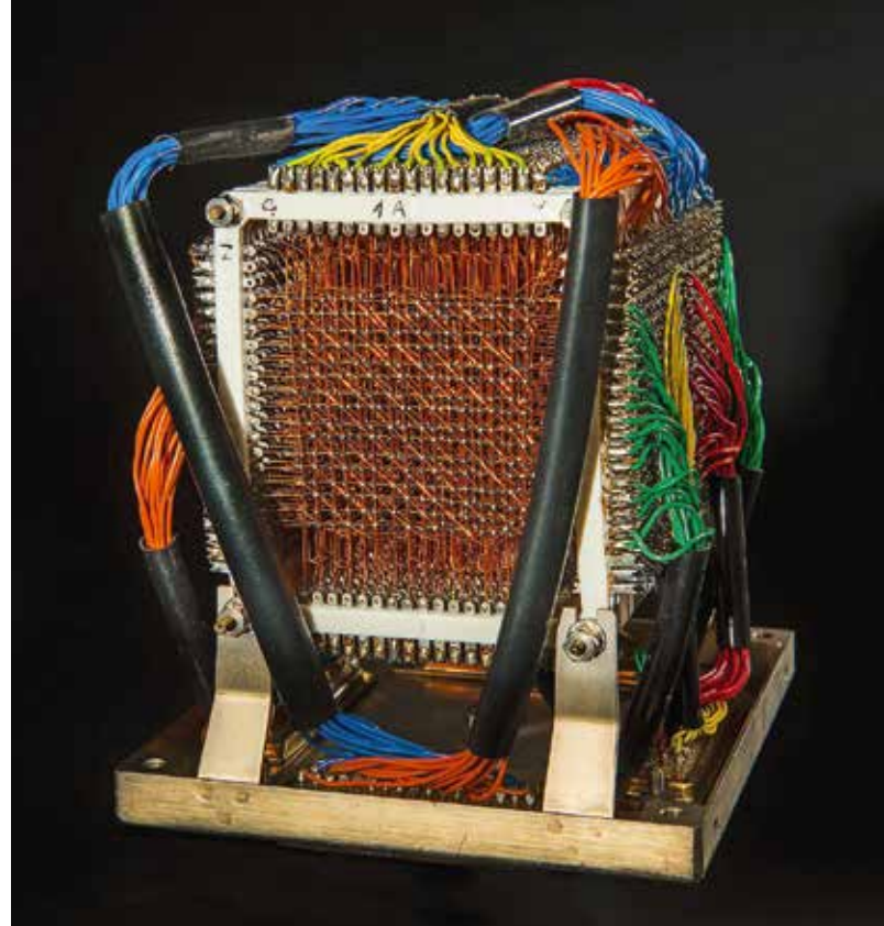
Jeder Ring ein Bit: Ringkernspeicher wurden in den 1950er bis 1970er Jahren als magnetische Speicher eingesetzt.
