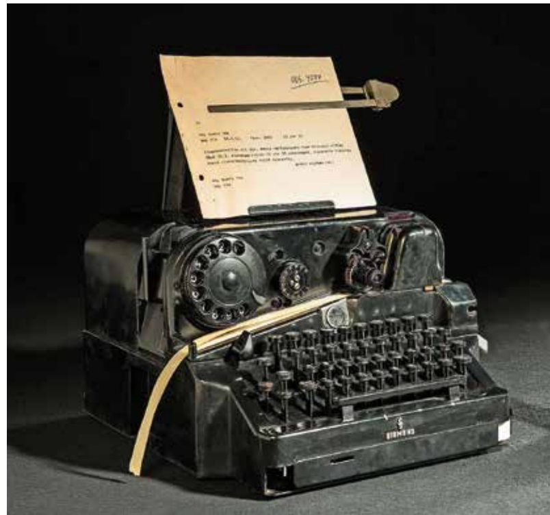
Fernschreiber Siemens T-68, 1951: Zur Übermittlung wird der Nachrichtentext auf einen schmalen Papierstreifen gedruckt.
