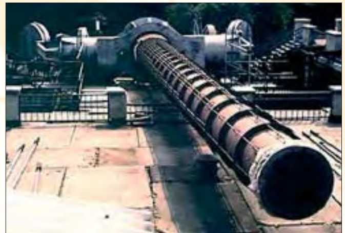
▲ Der innere Rohrtubus und das Kompensationssystem gegen die Rohrdurchbiegung. Foto: Wünsche
