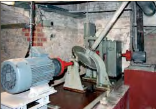
▲ Der Stundenantrieb zum Schneckenrad erfolgt über eine Welle, die Umschaltung zwischen der Grobbewegung und Nachführung elektromagnetisch über eine Kupplung. Foto: Rothenberg
