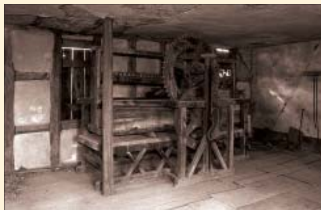
▲ Wäschemangel, entwickelt aus der Mühlentechnologie, um 1900, aus Monstab, Thüringen. Foto: C. Kirchner/DTM
