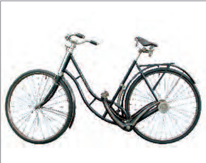
▲ Das „National Genie“ mit patentiertem Winkhebelantrieb ist eine elegante Erscheinung. © SDTB/Foto: B. Huth
