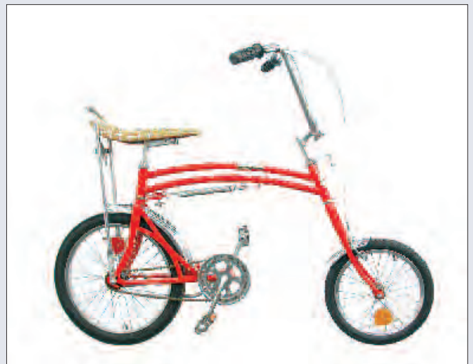
▲ Dieses Swingbike ist extravagant in Erscheinung und Technik. Es hat ein lenkbares Hinterrad. © SDTB/Foto: B. Huth
