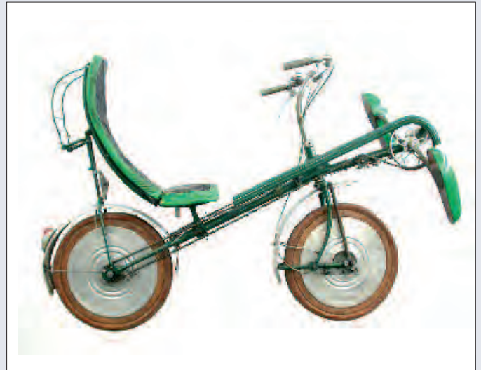
▲ Das Liegerad hat einen geringeren Luftwiderstand als ein normales Fahrrad. © SDTB/Foto: B. Huth
